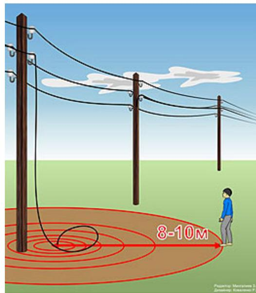
Угрозу жизни представляют не только свисающие или оборванные провода электросетей, но и провода линий радиотелефонной связи, которые могут схлестываться с проводами воздушных линий электросетей. Большую опасность представляют провода воздушных линий и ответвлений от них к постройкам, расположенные в кроне деревьев или кустарников. Нельзя раскачивать деревья вблизи линии электропередач. Сырое дерево служит проводником электрического тока.
